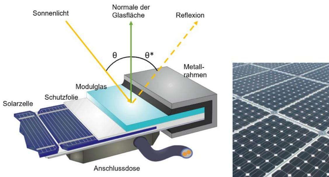
Abbildung 3: Aufbau eines PV-Moduls und Darstellung des Reflexionsgesetzes „Einfallswinkel = Ausfallswinkel“
