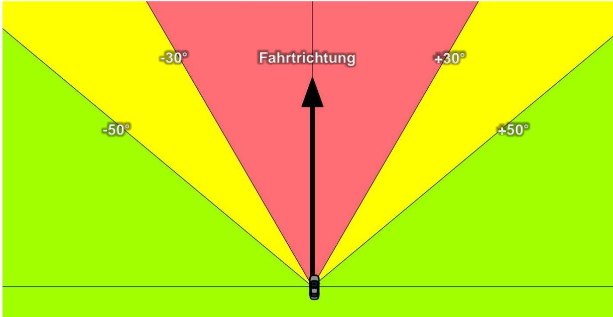
Abbildung 10: Definierte Sichtfelder eines Fahrzeugführers
