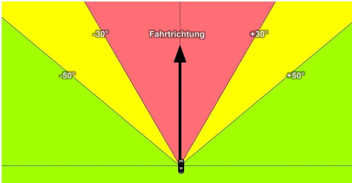
Abbildung 8: Definierte Sichtfelder eines Fahrzeugführers
